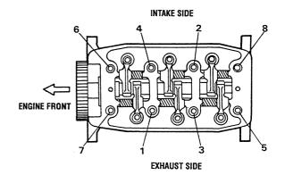
CYLINDER HEAD BOLTS TIGHTENING SEQUENCE
